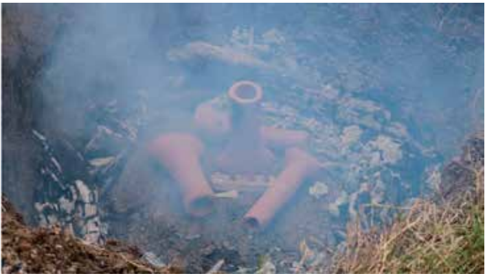
Piezas cerámicas horneadas en horno de hoyo a cielo abierto, proceso inspirado en algunas quemas amerindias.
